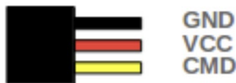
Figure 13 : Broches d'un servomoteur (Source : Lense)
